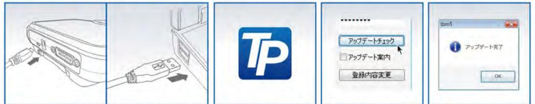
1 付属のmicroUSBケーブルでTPM-5本体とパソコンを繋ぎます。(PC接続モード) 2 アップデートソフトを起動します。 3 アップデートチェックをクリックします。 4 アップデート完了です。
